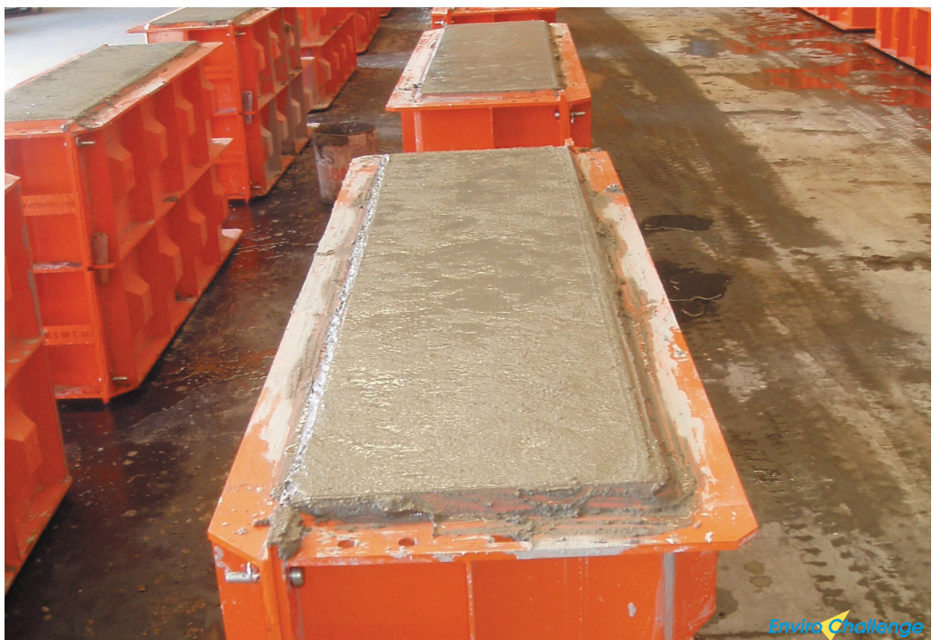
Illustratie 8 : Uitharden van betonproducten in mallen (samenstellingslijn)
