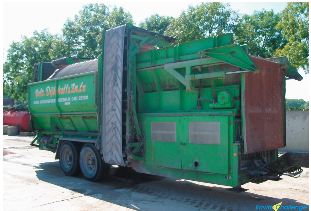
Illustratie 9 : Trommelzeef voor scheiden van grond van stenen en andere verontreinigingen (bouwmaterialen / zand / grond / grind-lijn)
