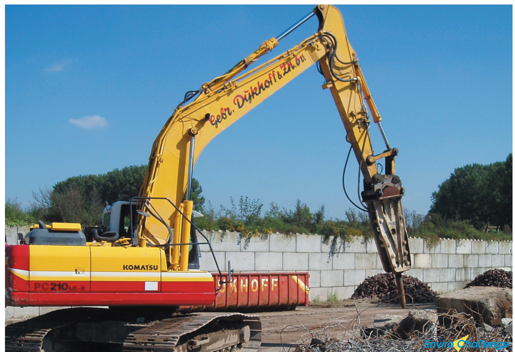
Illustratie 2 : Verkleining van grof puin met hydraulische hamer
