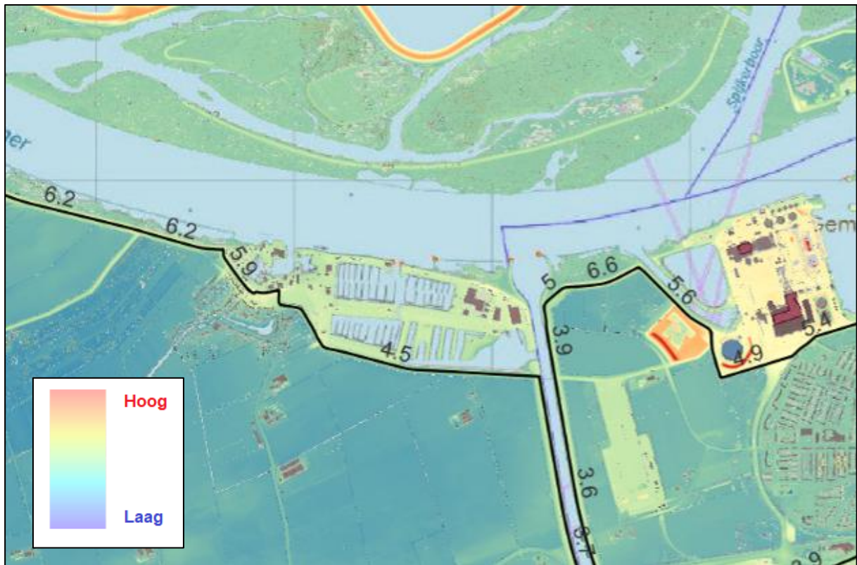
Figuur: Dijkhoogten in de omgeving, Aveco de Bondt, december 2022.
