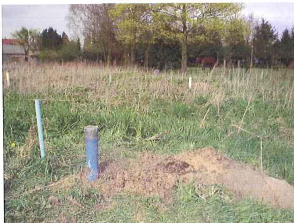
onttrekkingsfilters en peilbuizen
