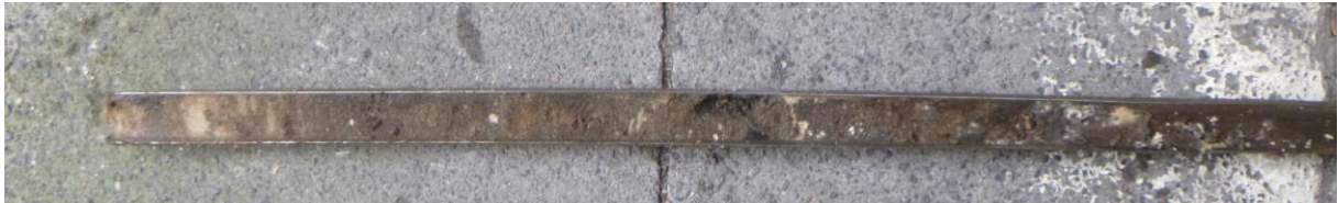
Figuur 25: Foto van boring 2 met de top laag van brokken zand van uiteenlopend humusgehalte die direct overgaat in het schone grijze zand van de C-horizont.
