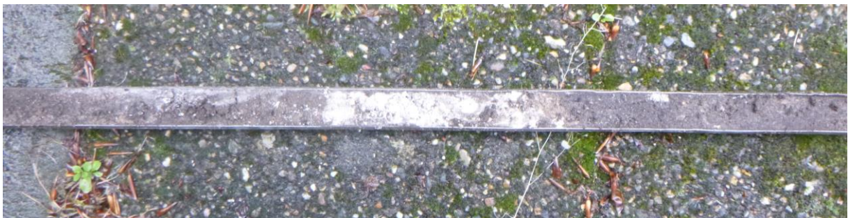
Figuur 26: Foto van boring 7 met de humusrijke top laag met daarin een grote hoeveelheid mortel die waarschijnlijk is vrijgekomen bij de sloop van de voorganger van de huidige woning.
