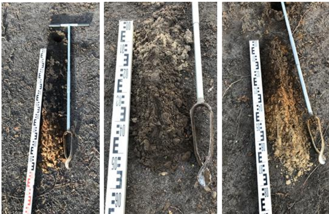
Figuur 7 3 van de 4 uitgevoerde boringen in het projectgebied. De bovenste laag in de middelste boring betreft humusarm straatzand. Aannemelijk is dat in het projectgebied tot een diepte van ca. 40 à 50 cm minus maaiveld matig humeus zand aanwezig is, met hieronder humusarm, geel zand.
