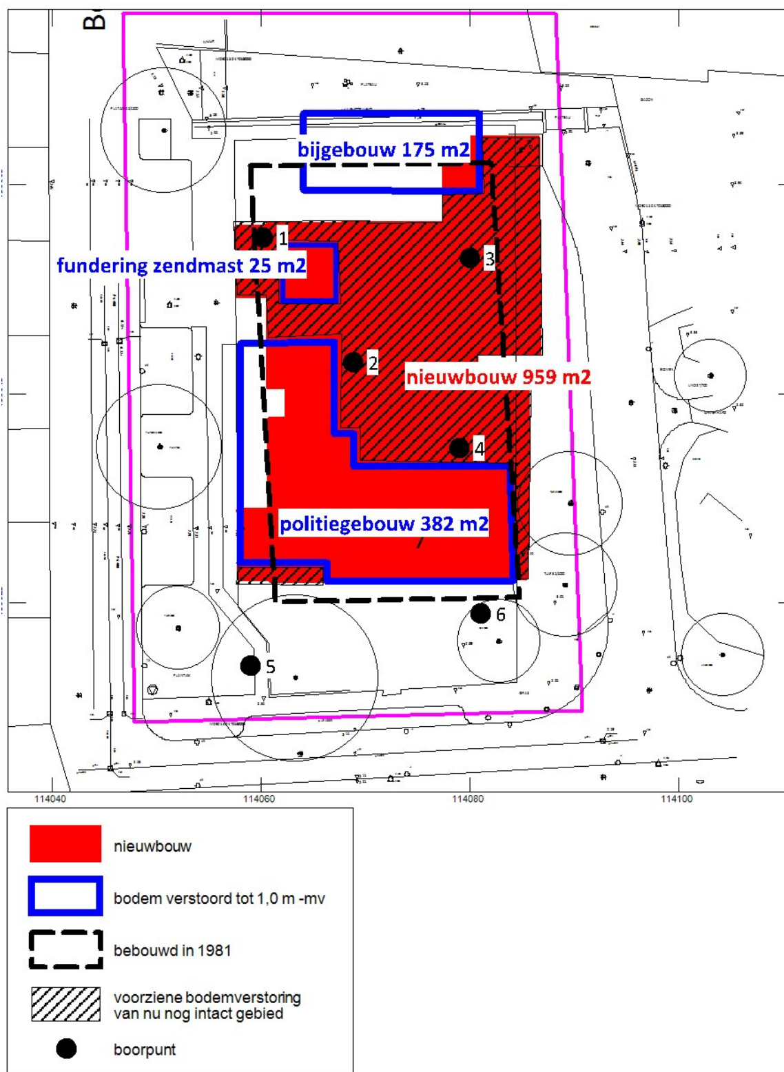
Afbeelding 9: Overzicht met de ligging van: boorpunten (1 t/m 6), bestaande verstoringen met oppervlaktes en de omvang van de voorziene nieuwbouw.
