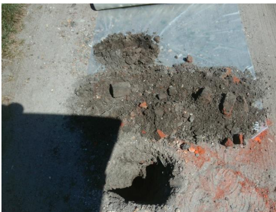
foto 5: Asbestinspectiegat deellocatie B: Vierendeelstraat en toegangsweg veldschuur
