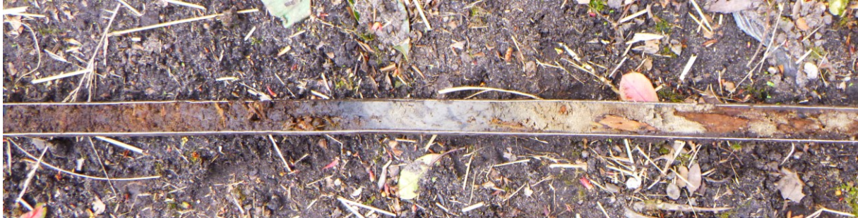
Figuur 24: Foto van boring 4 met links veen, in het midden klei dat in de top venig is en daaronder zandlaagjes bevat. Hieronder (rechts) is een pakket her-afgezet dekzand aanwezig dat wordt onderbroken door dunne laagjes veen.
