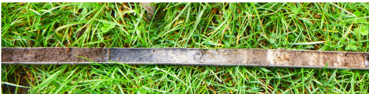
Figuur 23: Foto van boring 4 met links veen, in het midden klei dat in de top venig is en daaronder zandlaagjes bevat. Hieronder (rechts) is een pakket her-afgezet dekzand aanwezig dat wordt onderbroken door dunne laagjes veen.
