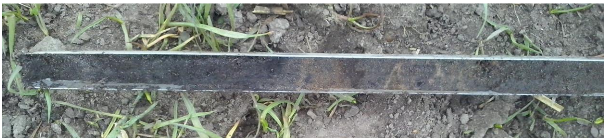
Figuur 17: Foto van boring 3 met rechts het rommelige pakket moerig zand en links de overgang naar matig veraard veen.
