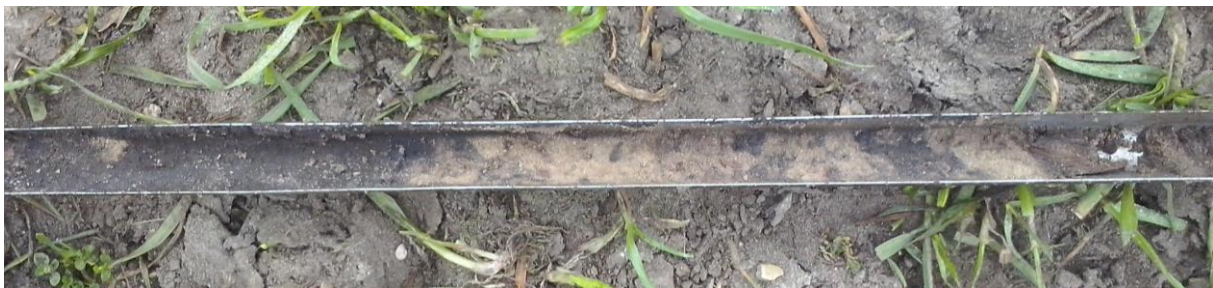
Figuur 18: Foto van boring 7 met rechts het rommelige pakket humusrijk zand met daarin brokken schoon zand en links het schone zand met daarin brokken van uiteenlopend humusgehalte.
