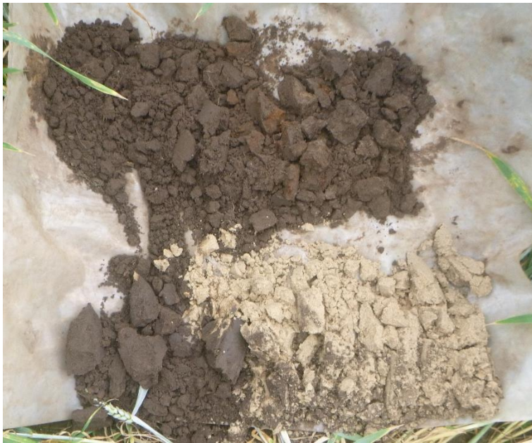
Fig. 3. Made – Kanaalweg-West. Boring 22 met geroerde, deels gevlekte bovenlaag direct overgaand in de C-horizont.
