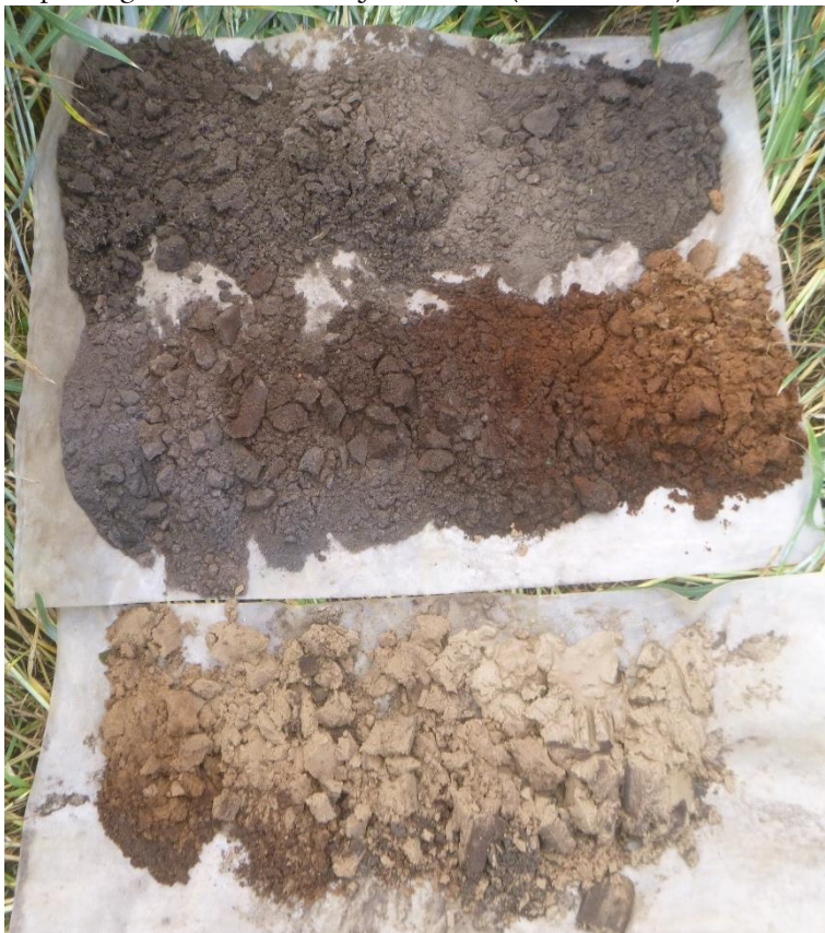
Fig. 3. Made – Kanaalweg-West. Boring 36 met vrijwel volledig intacte humuspodzolbodem.
