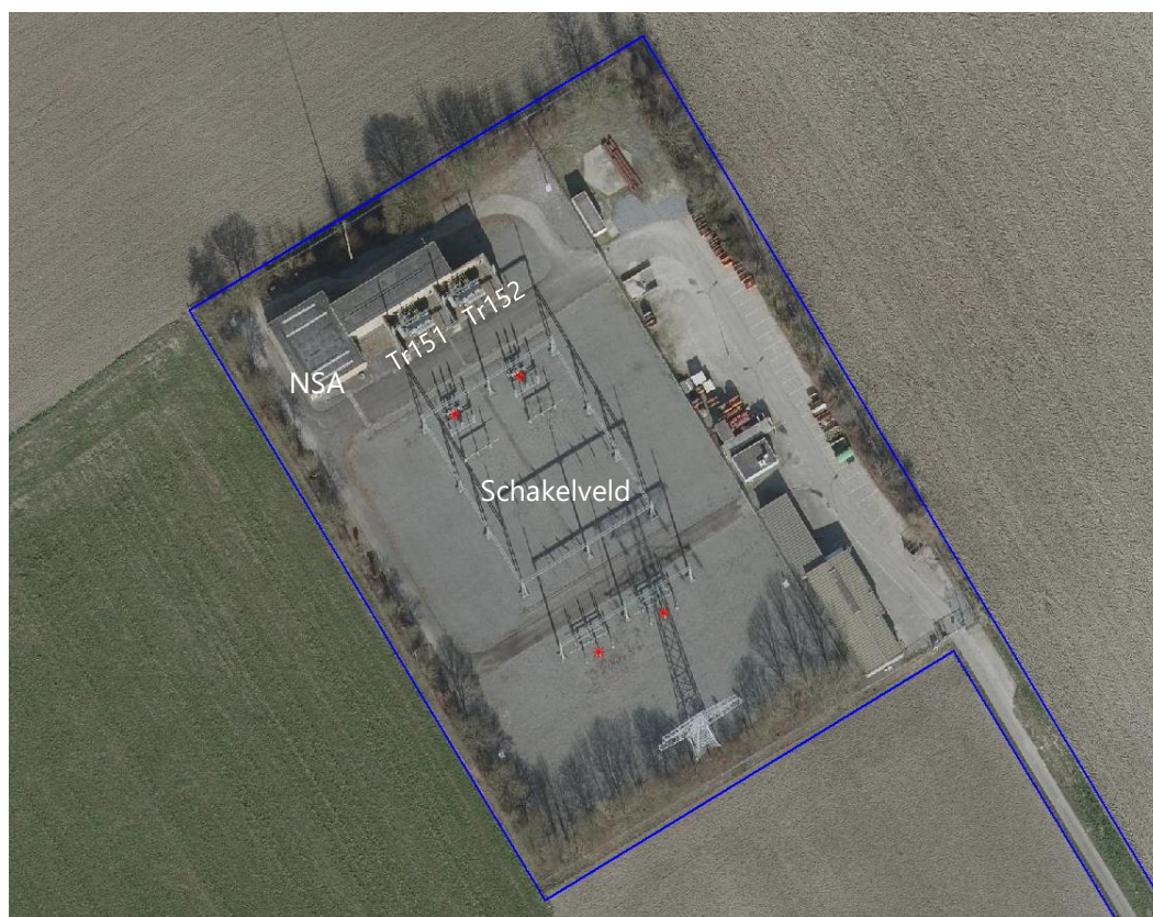
f 2.1 Lay-out HVS Oostburg (terreingrenzen in blauw, rode sterren zijn vermogensschakelaars)
