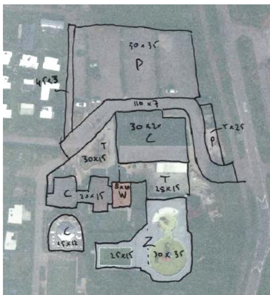
Figuur 12 Verhardingen in de huidige situatie. Maatvoeringen zijn opgenomen in de tabel.
