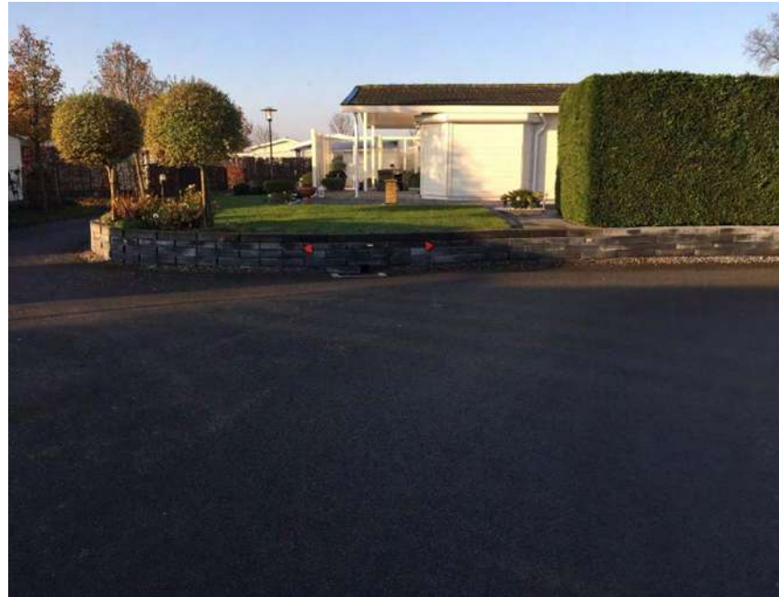
Figuur 3.30 Overbrugging van hoogteverschillen met donkere betonsteen.
