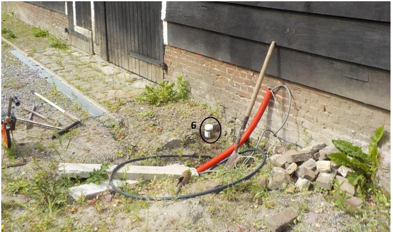
Foto 5: boring 6 tegen de gevel van de schuur.
