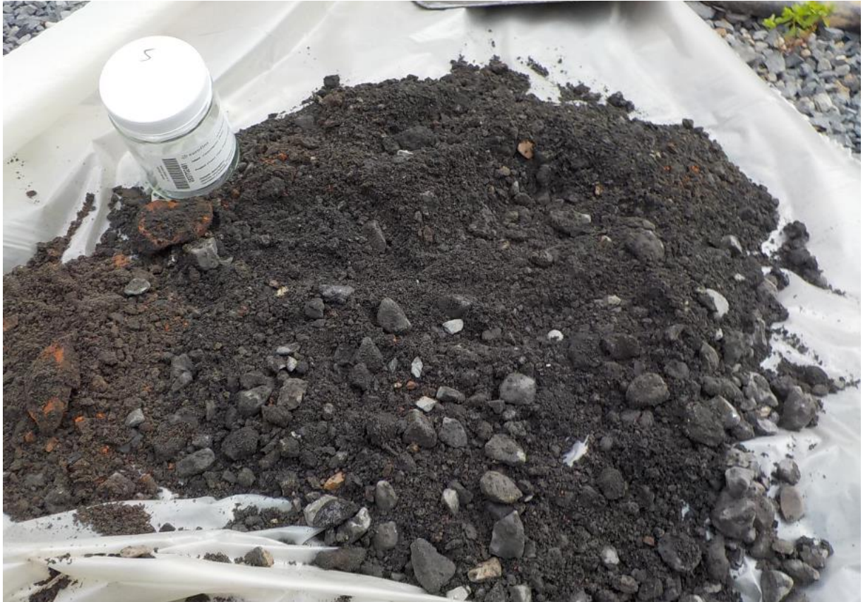
Foto 3: bodemvreemde materialen bij boring 5
