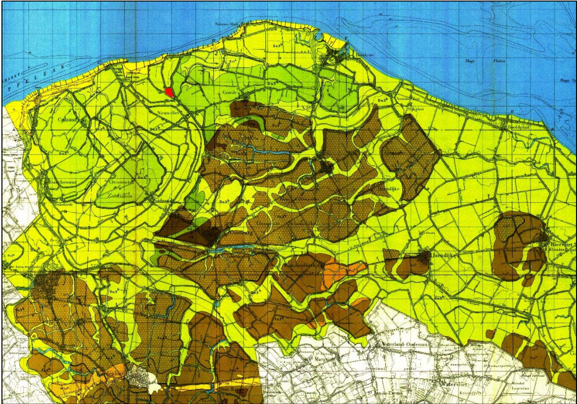
Afbeelding 7 Bewerkte geologische kaart van Nederland, blad West Zeeuws-Vlaanderen. De kleurverschillen en –contrasten zijn digitaal vergroot om het verschil tussen de kreekafzettingen (lichtgroen en groen) beter uit te doen komen ten opzichte van de zones waar in de ondergrond wel nog oudere archeologisch interessante geologische lagen en niveaus zoals het Hollandveen de afzettingen van het Laagpakket van Wormer (vroegere Calaisafzettingen). Het plangebied is rode aangegeven. Bron: Van Rummelen 1977a.
