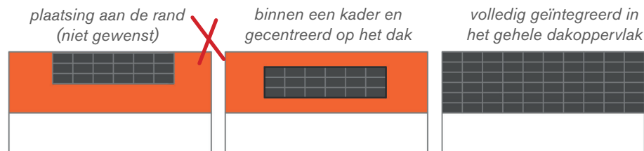
principe integratie zonnepanelen in de architectuur van de grote volumes
