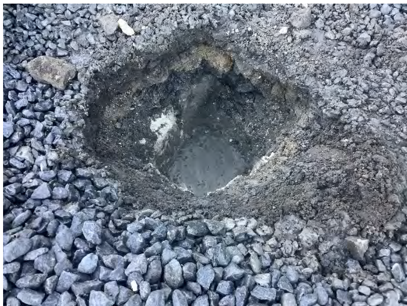
Figuur 30 Boring nr. 2 met onderin het uitgegraven gat de verharding waarop deze boring gestuit is. Bron: Artefact.
