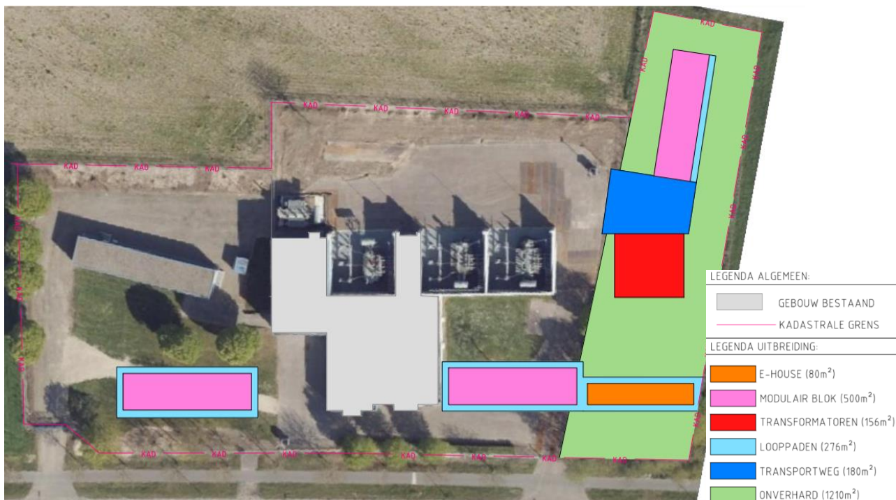
Figuur 7 Overzicht uitbreiding HS-station
