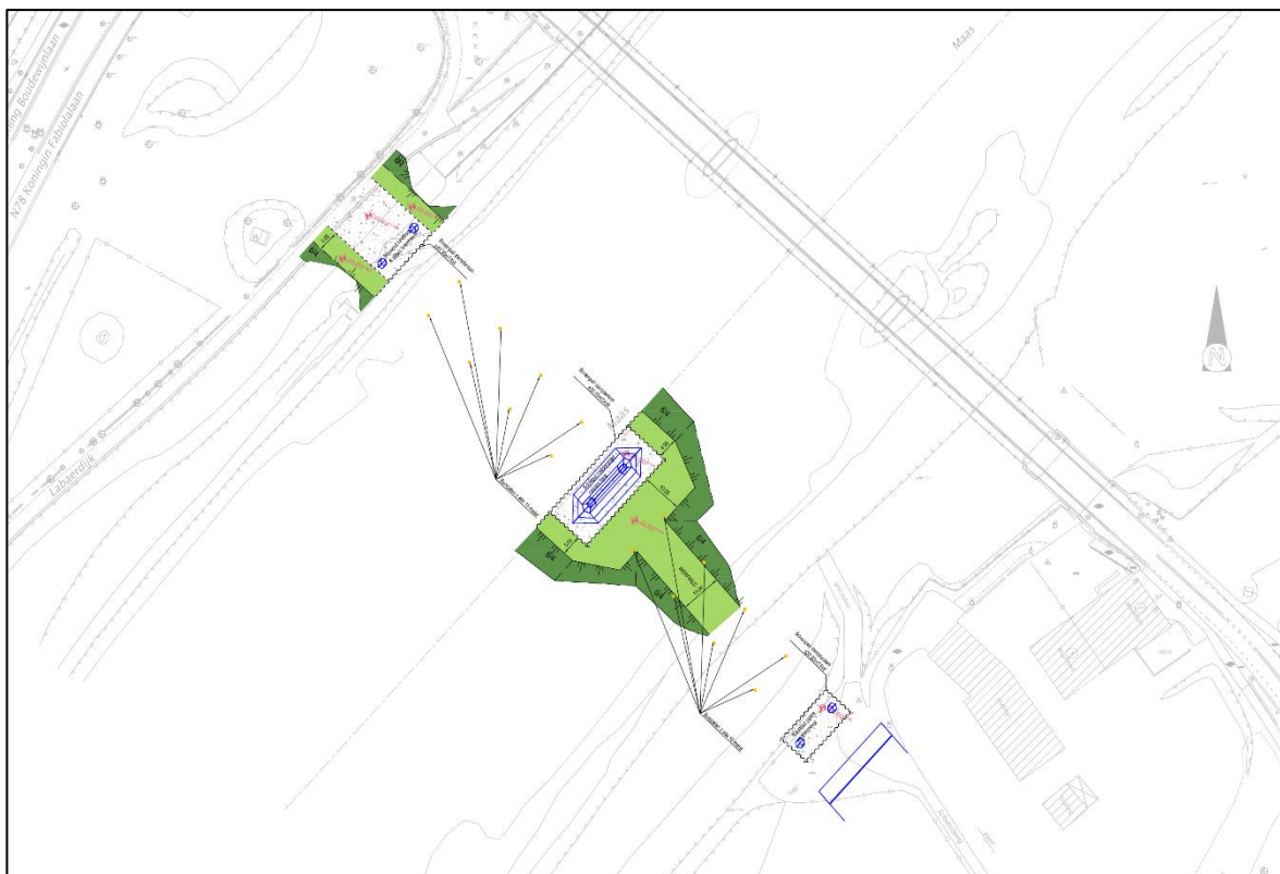
Figuur 2-4 Bouwfase pijlers met buispalen, bouwputten en toegangsdam vanuit de Schansberg (boven-aanzicht) met de bestaande brug nog in gebruik, bron: De Vlaamse Waterweg, 2023 (bewerkt)
