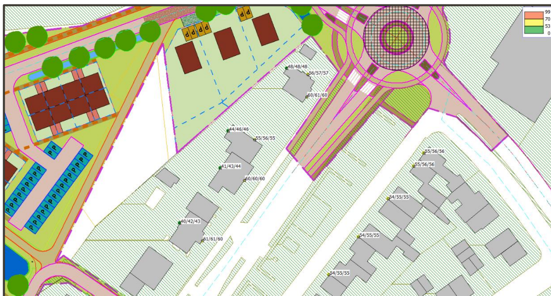
Afbeelding 9 Geluid op bestaande woningen vanwege (nieuwe) gemeentewegen
