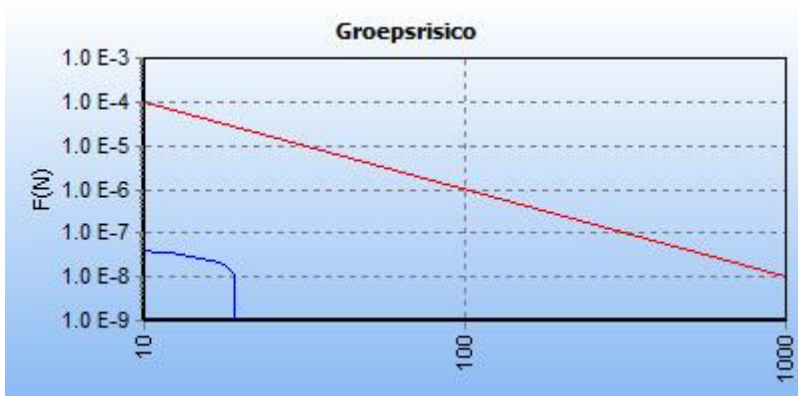
5.2 Figuur 5.2 FN curve voor 8311_leiding-A-578-deel-1 van N.V. Nederlandse Gasunie voor de kilometer tussen stationing 900.00 en stationing 1900.00
