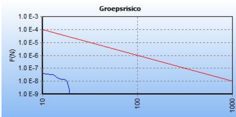
5.2 Figuur 5.2 FN curve voor 8311_leiding-A-578-deel-1 van N.V. Nederlandse Gasunie voor de kilometer tussen stationing 900.00 en stationing 1900.00
