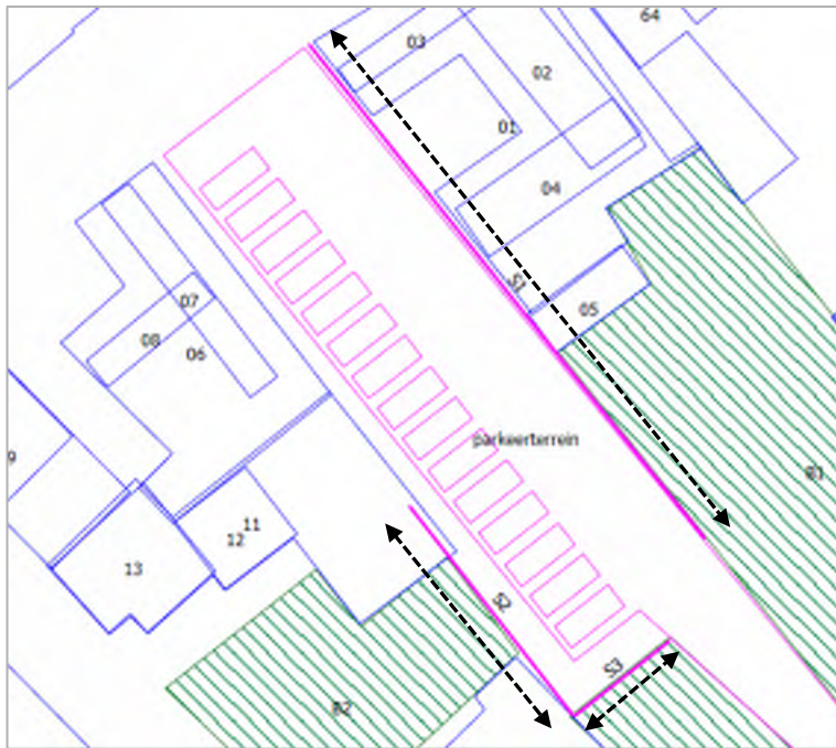
Figuur 9 Schermvariant, hoogte 2 meter, aan weerszijden geluidabsorberend
