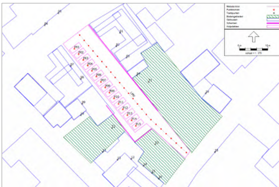
Figuur 8 Rekenmodel met geluidbronnen en rekenpunten
