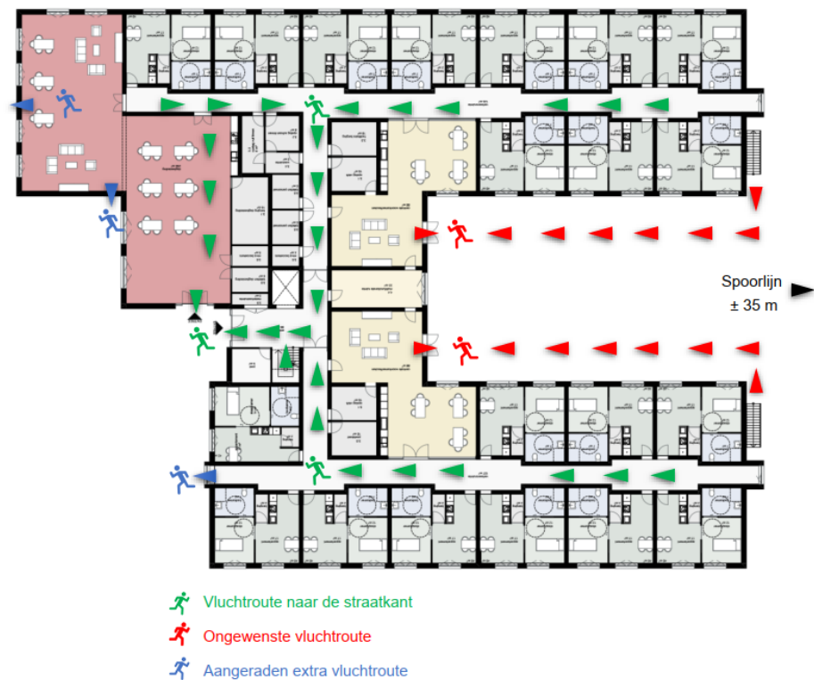
Figuur 4-1 Vluchtroutes in geval van een ramp
