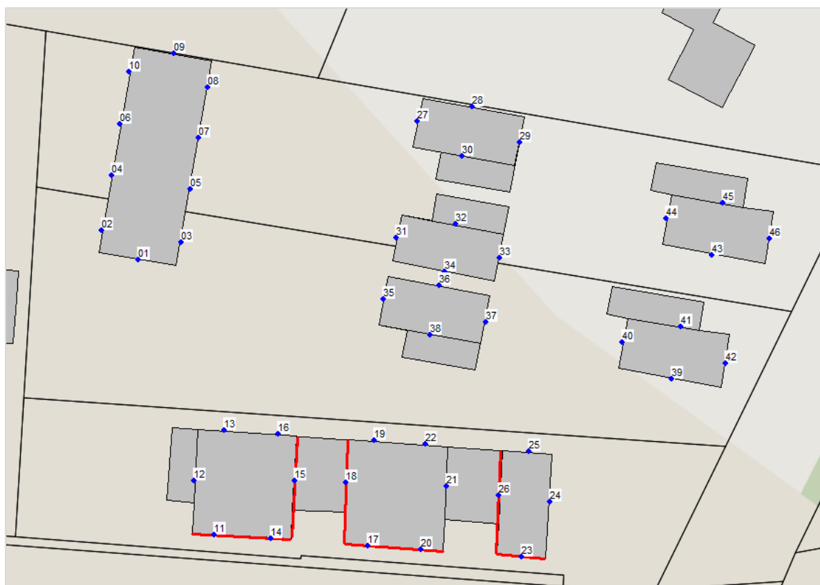
Figuur 5-1 situering benodigde dove gevels.
