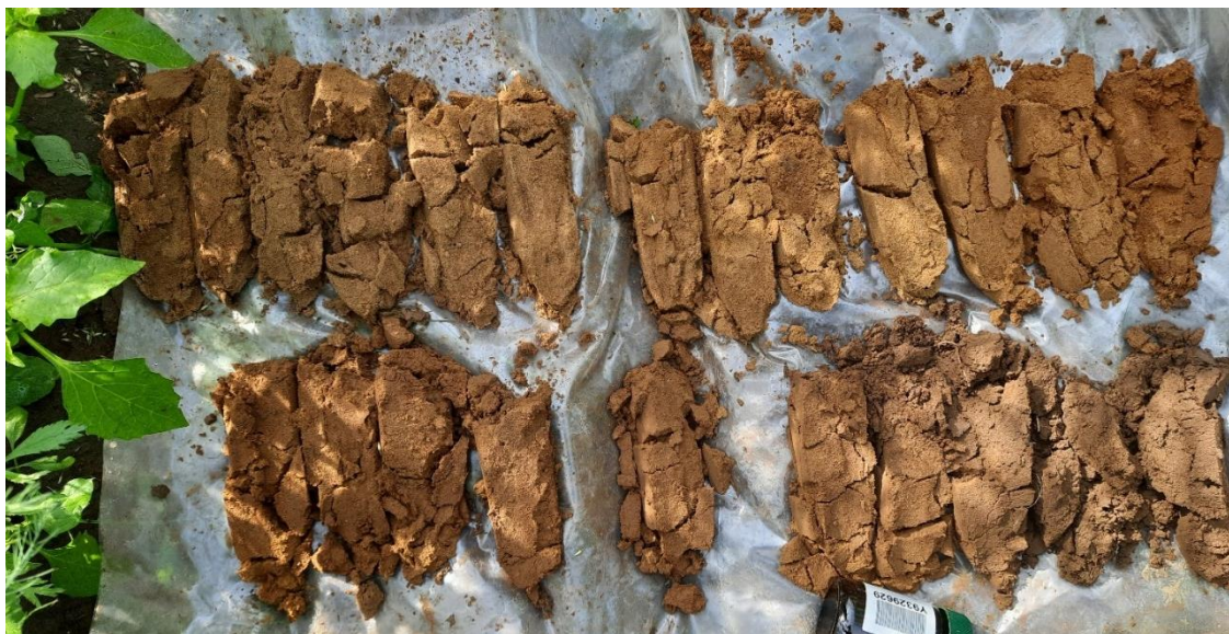
Afbeelding 5: Twee voorbeelden van een profielboring binnen het plangebied vanaf maaiveld (linksboven) tot 2 meter onder maaiveld (rechtsonder)
