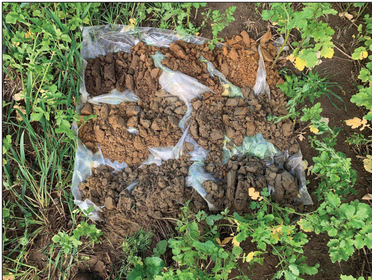
Afbeelding 8: Foto profielboring vanaf maaiveld (linksboven) tot einddiepte (rechtsonder).
