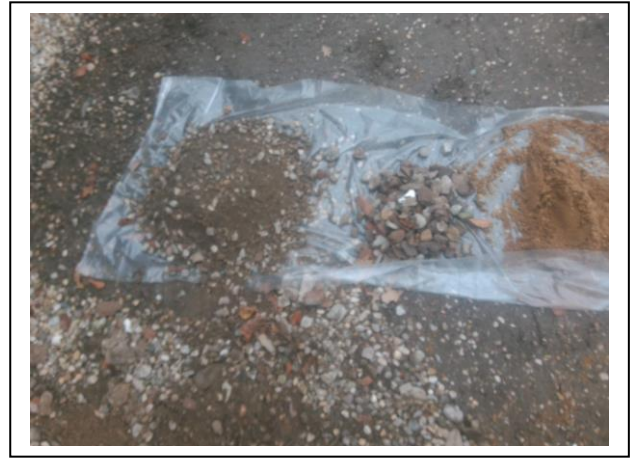
Foto 8. Opgegraven en gezeefd materiaal asbestinspectiegat 24
