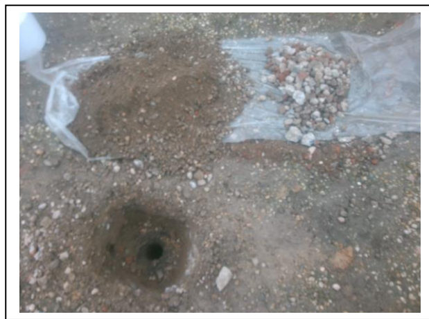
Foto 6. Opgegraven en gezeefd materiaal asbestinspectiegat 14
