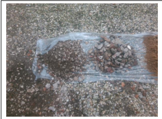
Foto 7. Opgegraven en gezeefd materiaal asbestinspectiegat 15
