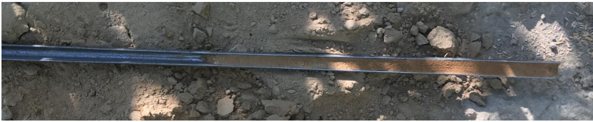
figuur 12. Overgang van de licht bruine gele C-horizont naar de bruine C-horizont in boring 2.
