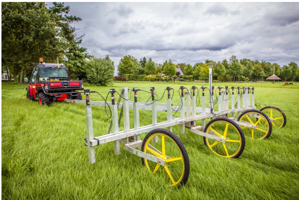
Afbeelding 2. Detectievoertuig zoals deze gebruikt is voor het uitvoeren van de computerondersteunde digitale oppervlakedetectie.
