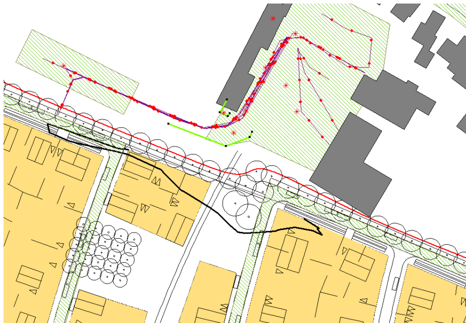
Figuur 5: 50 dB(A) etmaalwaarde-contour Van Meel Bouwmaterialen, na afscherming zaagmachine en laadschop
