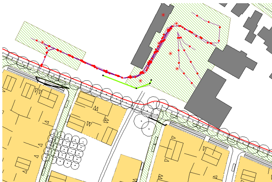
Figuur 7: 50 dB(A) etmaalwaarde-contour Van Meel Bouwmaterialen, bij een combinatie van het inpandig opstellen van de zaagmachine en afscherming laadschop
