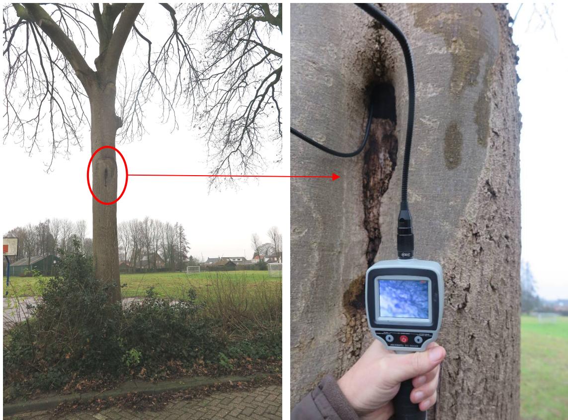
Figuur 5. Foto-impressie van de betreffende opening in de boom met een endoscoop.
