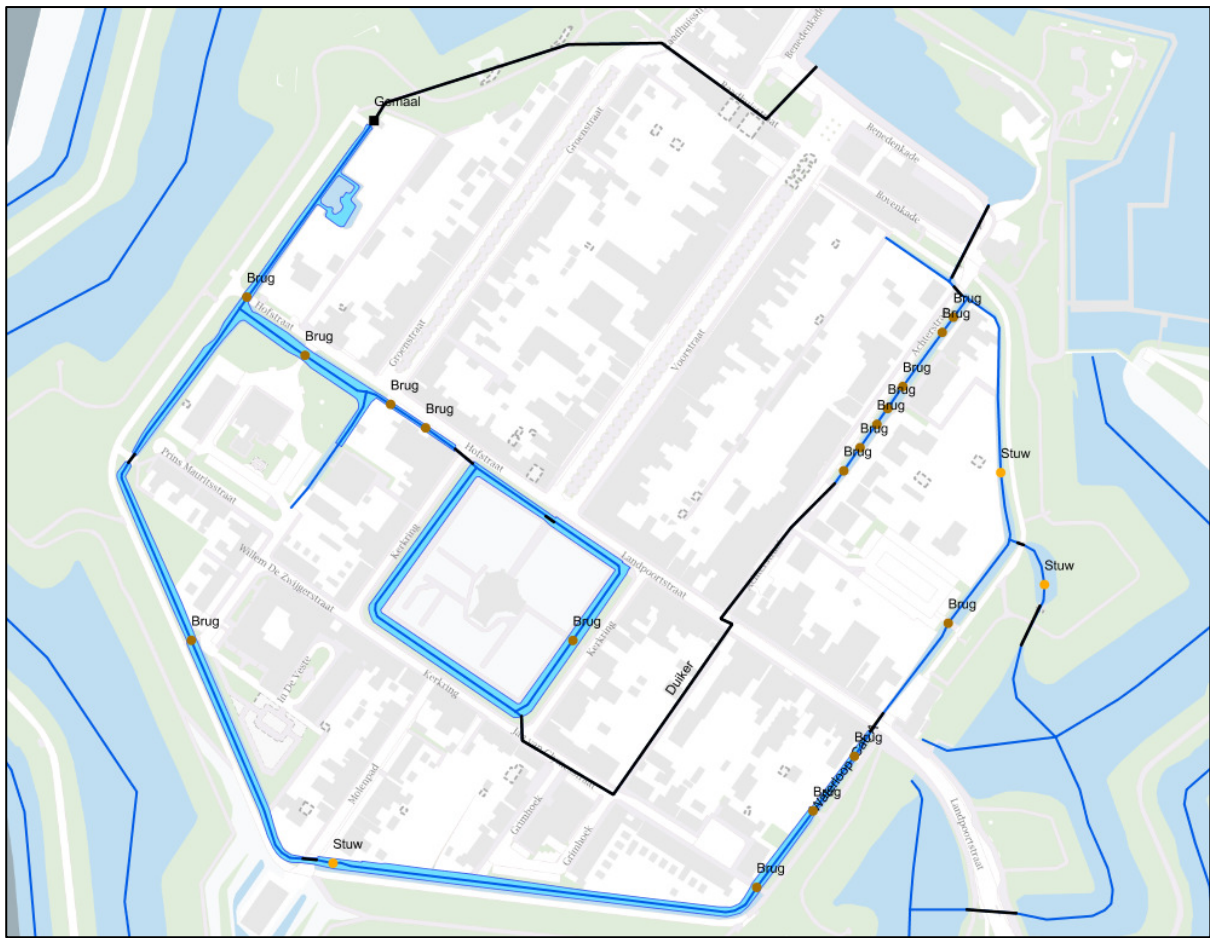
Uitsnede legger Waterschap Brabantse Delta ter plaatse van het plangebied. In blauw zijn de aanwezige oppervlaktewateren binnen de vesting weergegeven. Met een zwarte lijn is weergegeven waar een duiker is gelegen. Op de kaart is tevens de ligging van een gemaal, stuwen en bruggen aangegeven.
