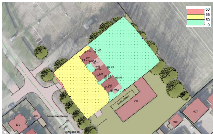
Figuur 3. Cumulatieve geluidbelasting (dB) op 1,5 meter hoogte
