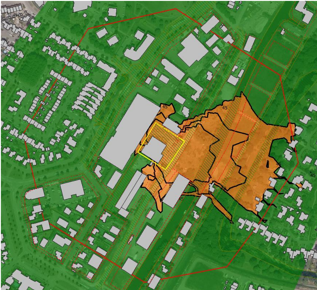
Figuur 6 rekenresultaten Tuysel-machinery incl. bebouwing + 200 meter contour. Weergegeven zijn de 45 – 50 en 55 dB(A) contouren.
