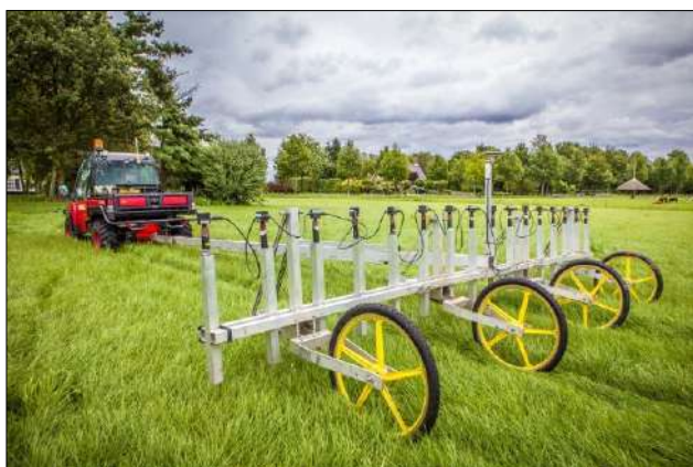
Figuur 30. Passieve non realtime oppervlakedetectie met het Vallon Multisondesysteem VXXV16 en een staafdiagram waarop het maximale detectiebereik (m² - maaiveld) per kaliber is weergegeven.
