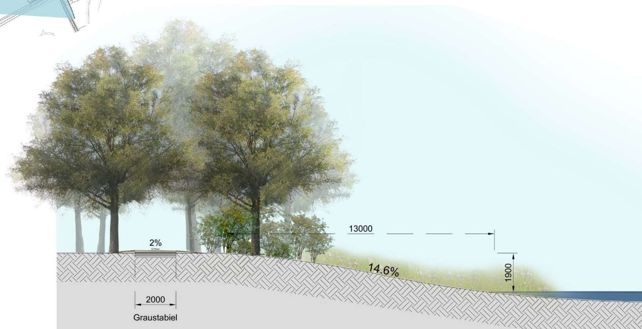
Principe doorsnede wadi, gevolgd door het kern - mantel - zoomprincipe
