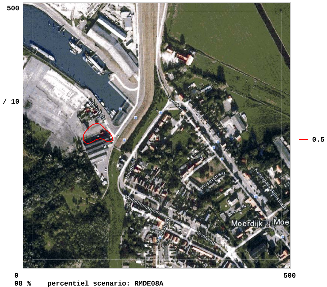
Figuur b Geurcontour van 0,5 \text{ ou}_E/\text{m}^3 als 98-percentielwaarde ten gevolge van Koman's Vishandel
