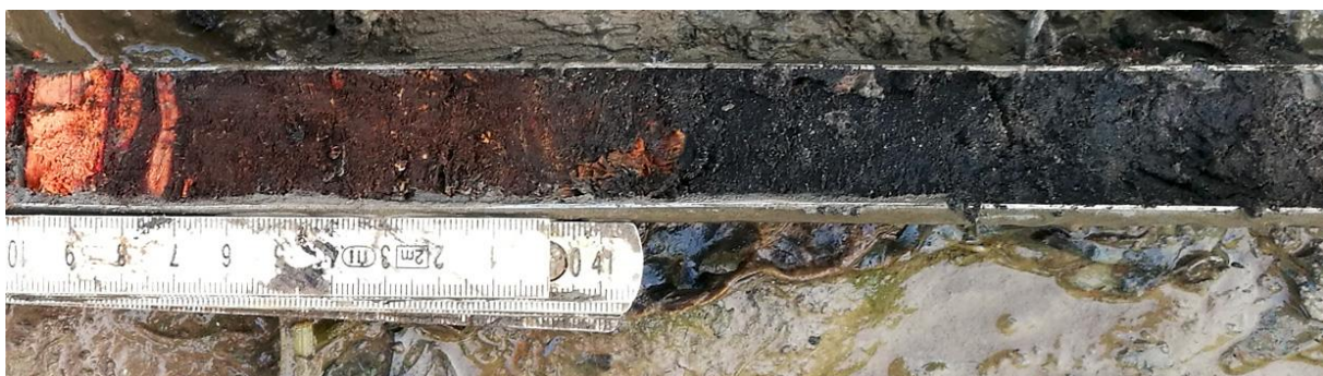
Afbeelding 18: Detail van boring 3 met daarin de overgang van het veen (links) met orangerode houtresten van Zwarte els naar de zwarte humeuze intacte top van het pakket dekzand. De overgang van veen naar dekzand ligt op circa 287 cm –mv.
