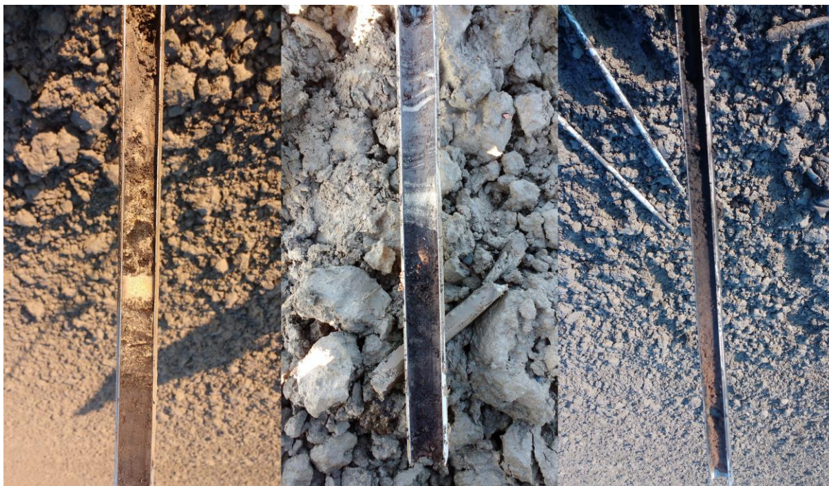
Figuur 8. Foto's van (a, links) het rommelige moerneringspakket en de overgang naar het veen, (b, midden) de erosieve overgang van sterk gelaagde getijde(geul)afzettingen naar het veen en (c, rechts) de overgang van het veen naar het dekzand.
