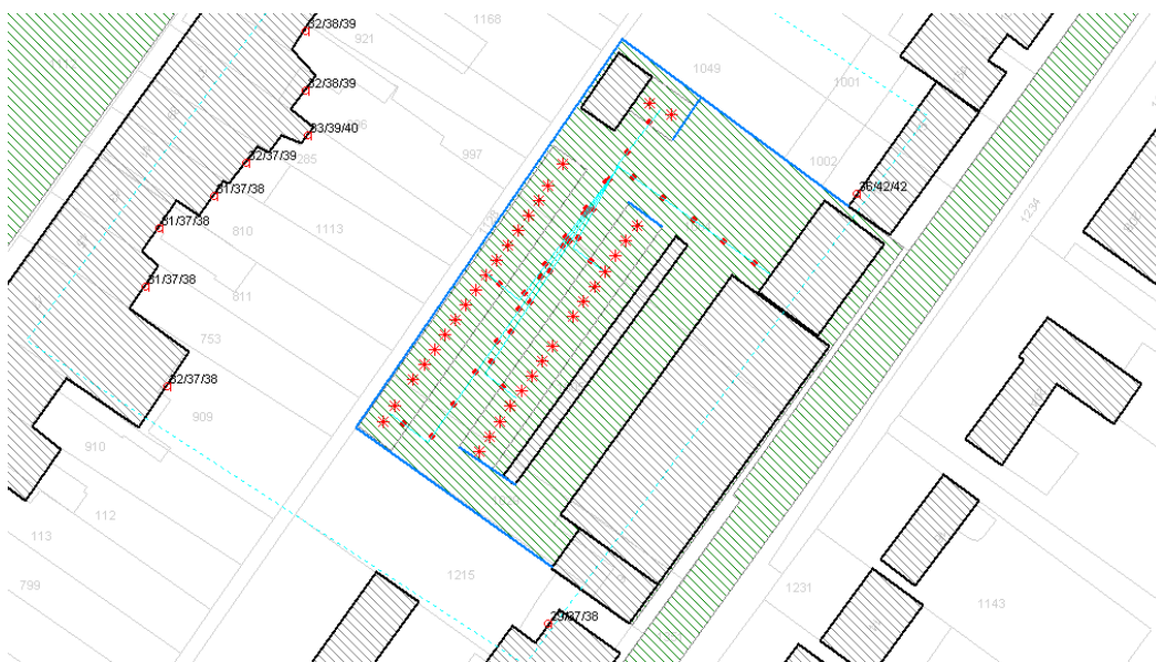
Figuur B2b. Langtijdgemiddelde beoordelingsniveaus t.p.v. woningen –situatie met extra afschermingen conform figuur B2a
