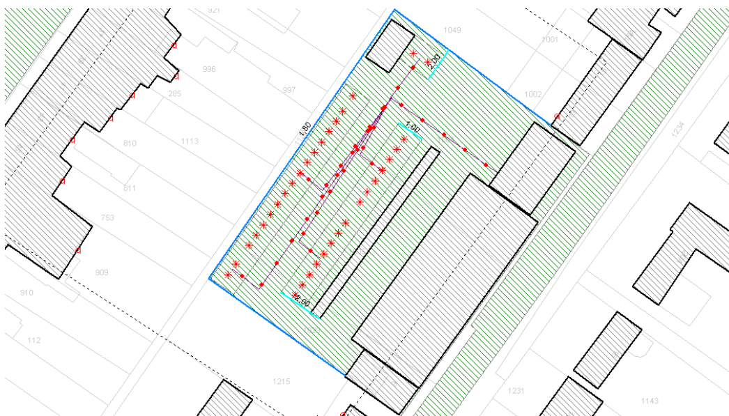
Figuur B2a. Mogelijkheid afscherming bij toetsing L_{max} aan 60 dB(A) in nachtperiode t.p.v. woningen Achterstraat 5 en 13 [lichtblauw: aanvullende afscherming met hoogten ten opzichte van maaiveld]
