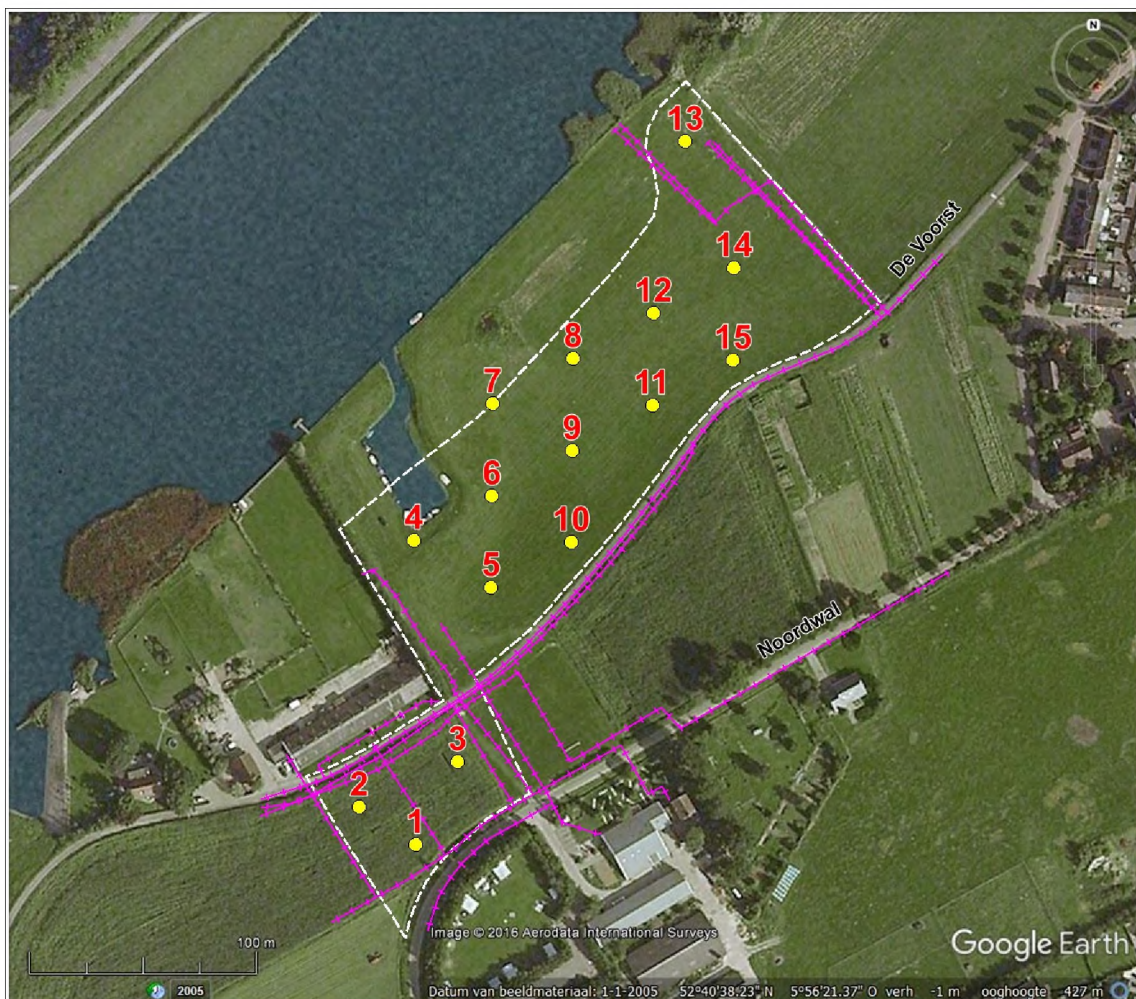
Figuur 10: Vollenhove, Noordwal 3: boorpuntenkaart. De genummerde punten zijn de locaties van de vijftien boringen. De roze lijnen geven de ligging van leidingen weer.
