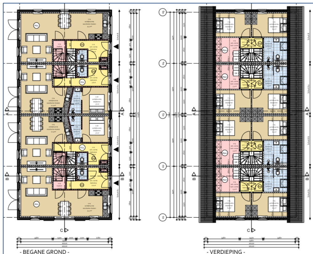
Fig. 2.9: Een impressie van de indeling van de begane grond en de verdieping (type 'schuur').
