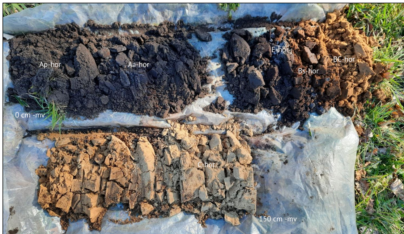
Figuur 8. Foto van boring 45. De leesrichting is van linksboven naar rechtsonder (0 – 150 centimeter): donkergrijs opgebracht (sub-)recent pakket, matig humeus (donker) bruingrijs bouwvoor, grijze E-horizont, humeus bruin zand (B-horizont) die geleidelijk overgaat (BC-horizont) naar de (licht) gele kleur (C-horizont) (Foto: 9 maart 2022).
