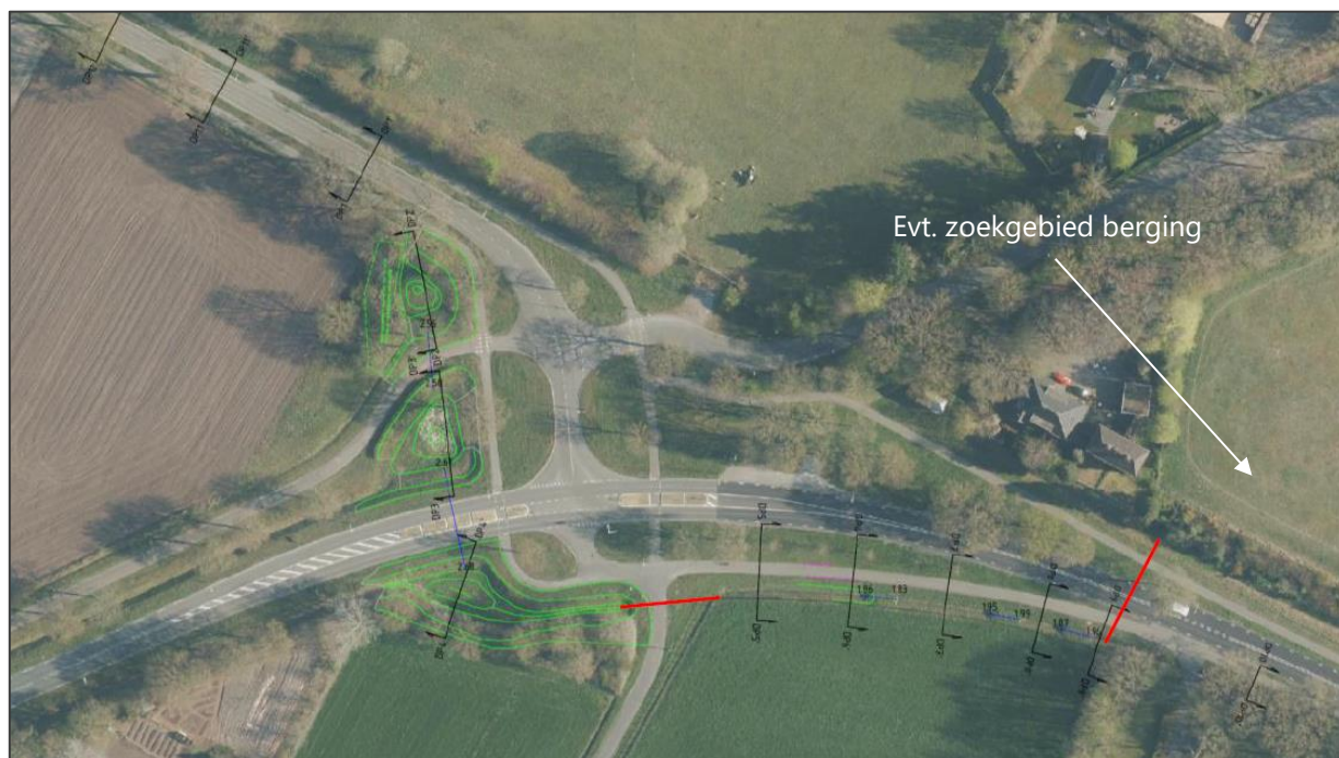
Afbeelding 3.2: Onderling verbinden wadi's en creëren afstroom naar noordelijke zaksloot (rood)
