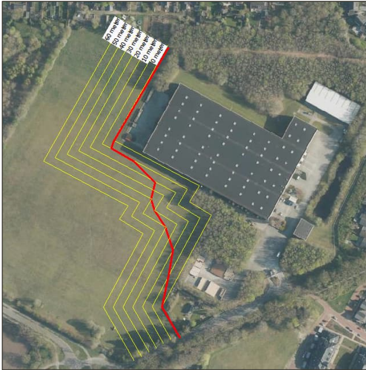
Afbeelding 7 Maximale geluidniveaus, vanaf de rode lijn wordt voldaan aan de richtwaarde uit de VNG-publicatie van 70 dB(A) in de dagperiode
