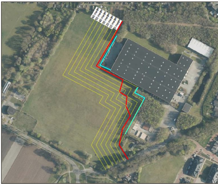
Afbeelding 8 Maximale geluidniveaus, vanaf de rode lijn wordt voldaan aan de richtwaarde uit de VNG-publicatie van 70 dB(A) in de dagperiode met een scherm van 2 meter boven plaatselijk maaiveld
