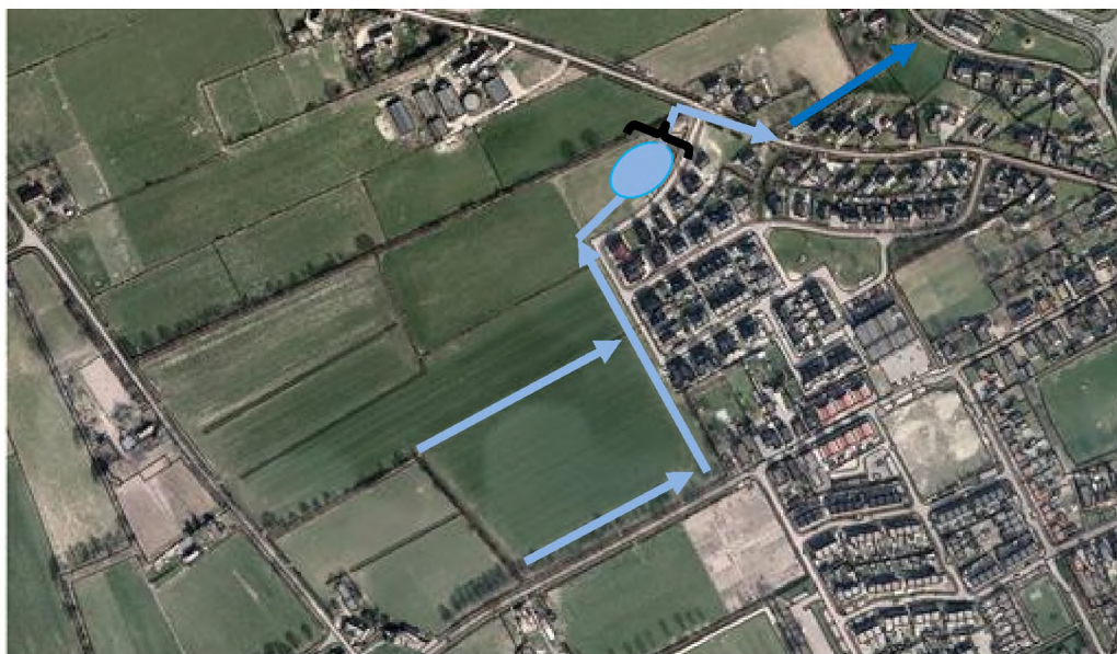
Figuur 3: Ontwatering en afwatering woningbouw Molenkampen III
