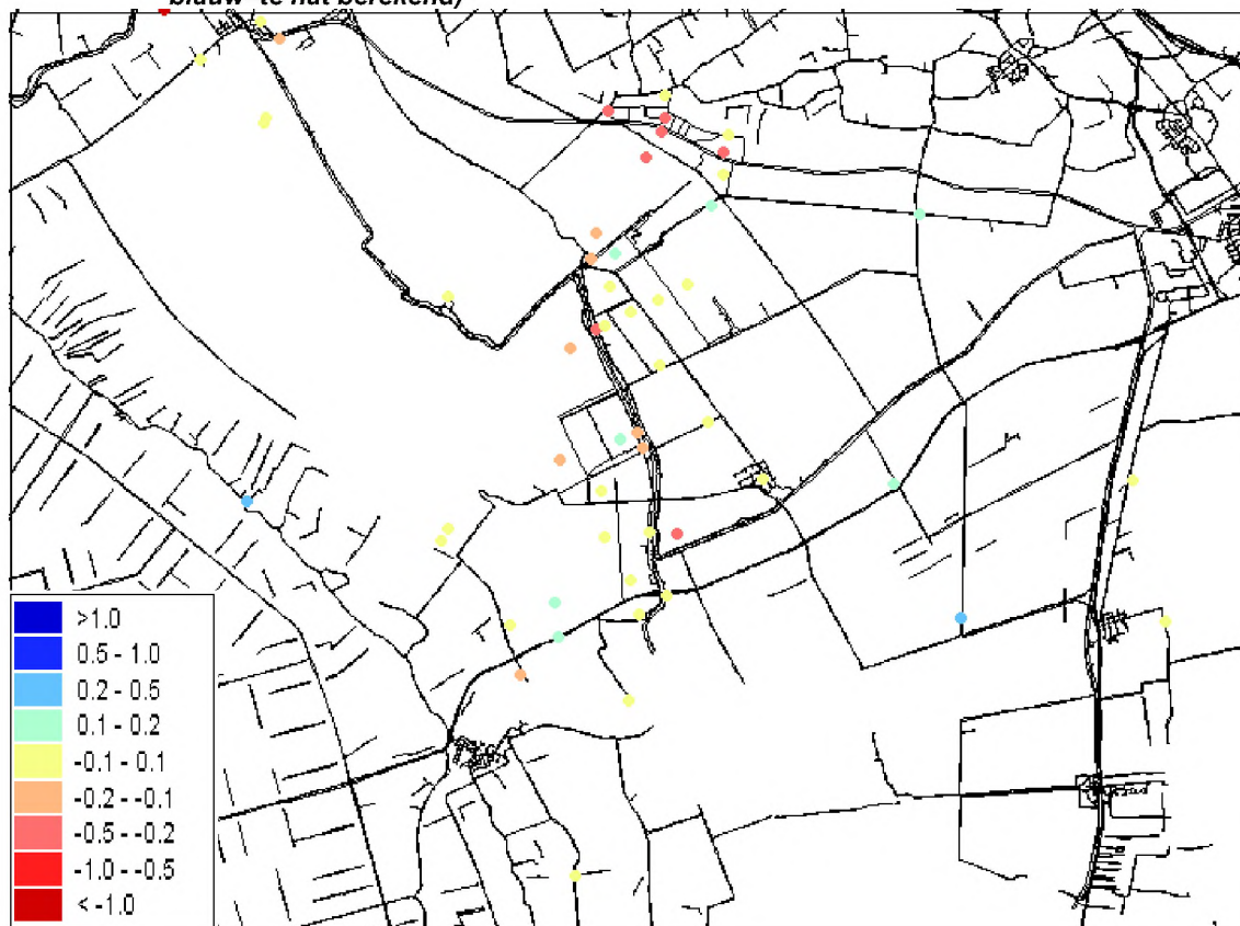
Figuur 2.3 Bollenkaart GVG laag 2, eerste watervoerend pakket (rood= te droog berekend, blauw=te nat berekend)
