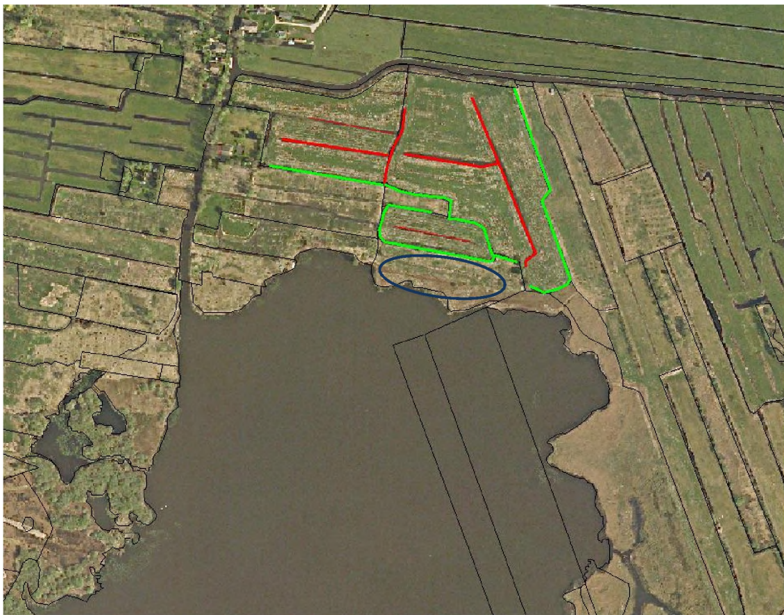
Figuur 2-4 - Inrichtingsplan voor de aanleg van Roerdomphabitat ten noorden van de Zuideindigerwijde. Weergegeven zijn sloten, waarvan de oevers verlaagd worden, zodat waterriet tot ontwikkeling komt, en een rietperceel waarvan het maaiveld verlaagd wordt. Rood: sloten waarvan beide oevers worden verlaagd, groen: sloten waarvan één zijde van de oever wordt verlaagd, blauw: zoekgebied voor het verlagen van het maaiveld ten behoeve van een broedlocatie. Bron: Natuurmonumenten.
