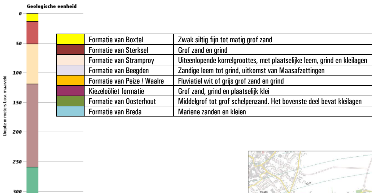
Figuur A: opbouw ondergrond.
